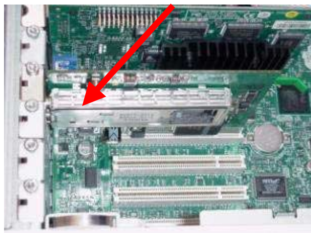
Számítógépbe beépített DVB-S PC kártya (példa)
